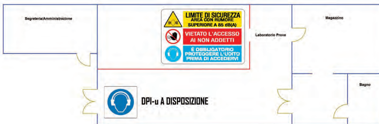
FIGURA 26 - PLANIMETRIA DEL LABORATORIO PROVE - SEGNALETICA RUMORE
